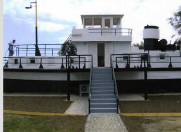
6. „Balaton” csavaros gőzhajó (ex Alexandra, ex Mohács, ex Irma, ex FK-312, épült: Újpest, Veruda Péter hajógyára, 1872; hossza: 30,3 m, szélessége: 4,9 m, oldalmagassága: 1,98 m, merülése: 1,3 m) (örzési helye: 8630 Balatonboglár, Kikötő, hrsz: 1616/1.)
